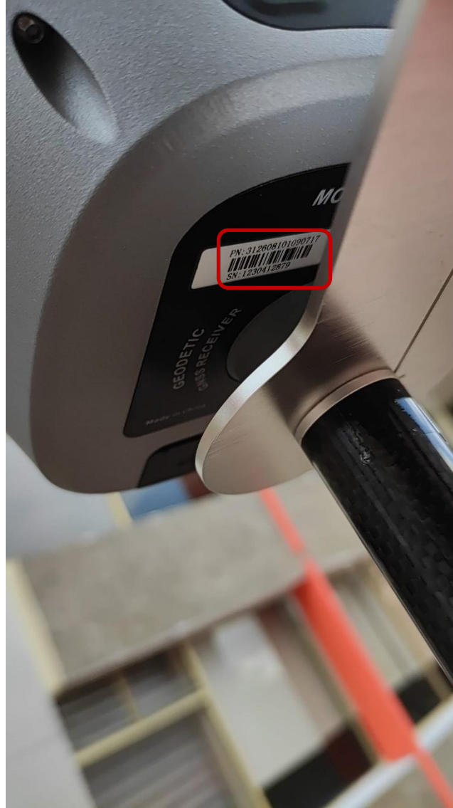
Fig.8.2. Etiqueta del Serial Number (SN) en antenas AllyNav R26.
